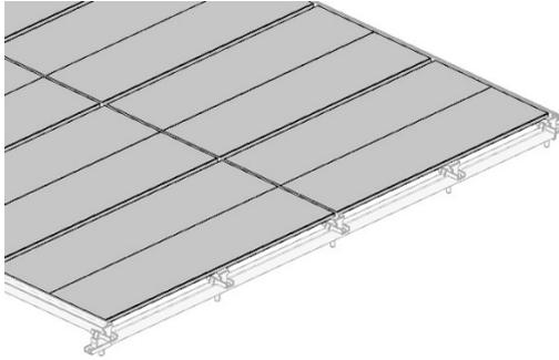
Durante el montaje de los tableros sobre la estructura formada por las vigas metálicas, se debe considerar el uso de líneas de vida o redes de seguridad bajo forjados.
