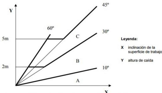
Fig. 1 "Clases para utilizar en diferentes inclinaciones y alturas de caída"
