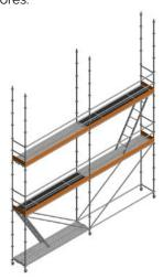
12. Colocamos las plataformas en el nivel superior, no olvidar de colocar los pasadores que llevan incorporados las plataformas para evitar su desmontaje accidental. Para acceder al piso superior se utilizará la escalera de la plataforma de acceso. Comprobar la separación del andamio a la fachada con las cotas indicadas en el proyecto.
