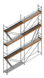
Una vez el montador ha subido al piso superior deberá colocar los largueros horizontales longitudinales que sirven de barandilla de protección a lo largo del andamio, así como el rodapié. Colocará los largueros que queden detrás de la barandilla de montaje, y cuando estén colocados, se reposicionará la barandilla de montaje al módulo contiguo, moverá la barandilla de montaje al módulo contiguo y se repetirá la operación.
