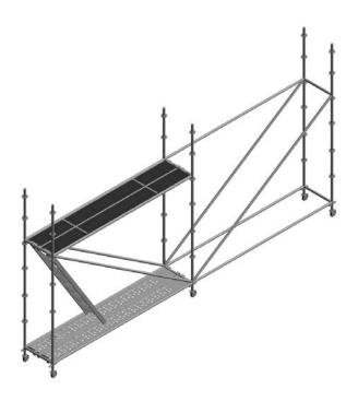
Colocamos las plataformas en el nivel superior, no olvidar de colocar los pasadores que llevan incorporados las plataformas para evitar su desmontaje accidental. Para acceder al piso superior se utilizará la escalera de la plataforma de acceso. Comprobar la separación del andamio a la fachada con las cotas indicadas en el proyecto.
