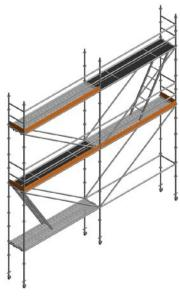
10. Siguiendo los pasos ya descritos, procedemos a colocar los Estabilizadores, obteniendo así una mayor rigidez, para terminar dicho montaje.
