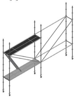
4. Colocamos las plataformas en el nivel superior, no olvidar de colocar los pasadores que llevan incorporados las plataformas para evitar su desmontaje accidental. Para acceder al piso superior se utilizará la escalera de la plataforma de acceso. Comprobar la separación del andamio a la fachada con las cotas indicadas en el proyecto.
