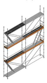
13. Una vez instalado el cuerpo del andamio y antes de seguir montándole el siguiente nivel, se procederá a la comprobación de la nivelación vertical y horizontal con un nivel de burbuja o láser.
