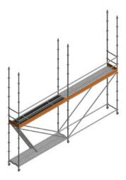
Colocamos las plataformas en el nivel superior, no olvidar de colocar los pasadores que llevan incorporados las plataformas para evitar su desmontaje accidental. Para acceder al piso superior se utilizará la escalera de la plataforma de acceso. Comprobar la separación del andamio a la fachada con las cotas indicadas en el proyecto.
