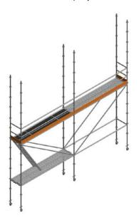
Colocamos las plataformas en el nivel superior, no olvidar de colocar los pasadores que llevan incorporados las plataformas para evitar su desmontaje accidental. Para acceder al piso superior se utilizará la escalera de la plataforma de acceso. Comprobar la separación del andamio a la fachada con las cotas indicadas en el proyecto.
