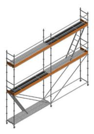
Una vez el montador ha subido al piso superior deberá colocar los largueros horizontales longitudinales que sirven de barandilla de protección a lo largo del andamio, así como el rodapié. Colocará los largueros que queden detrás de la barandilla de montaje, y cuando estén colocados, se reposicionará la barandilla de montaje al módulo contiguo, moverá la barandilla de montaje al módulo contiguo y se repetirá la operación.
