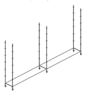
Colocamos los largueros horizontales transversales y longitudinales a 2 m de altura, equivalente al 4º disco (roseta) respecto del iniciador. Se debe fijarlos golpeando la cuña con una maza. Sobre 2 largueros cortos contiguos se montará una plataforma de acceso con la escalera desplegada sobre 2 plataformas de acero, para poder acceder posteriormente al nivel superior.
