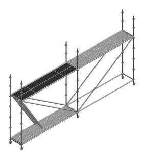
Una vez instalado el cuerpo del andamio y antes de seguir montándole el siguiente nivel, se procederá a la comprobación de la nivelación vertical y horizontal con un nivel de burbuja o láser.
