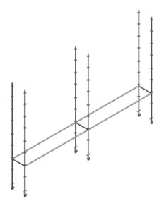
3. Colocamos los largueros horizontales transversales y longitudinales a 2 m de altura, equivalente al 4º disco (roseta) respecto del iniciador. Se debe fijarlos golpeando la cuña con una maza. Sobre 2 largueros cortos contiguos se montará una plataforma de acceso con la escalera desplegada sobre 2 plataformas de acero, para poder acceder posteriormente al nivel superior.
